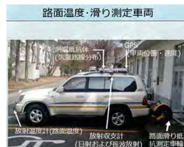
図 2. 路面の滑り抵抗および路面温度の路線方向変化を測定するために使用した特殊車両、国内の大学では唯一の装置である。
