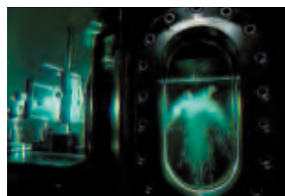
新しい燃料に支えられた新方式の自動車エンジン燃焼を研究(噴霧の微細構造の研究風景)
