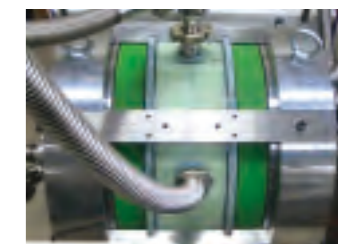
[上] 全超伝導電動機 世界で初めての全超伝導・液体窒素冷却の電動機(パワーエレクトロニクス研究室) [左] デバイス特性評価装置 窒化物半導体を用いた新構造トランジスタの基本特性を測定(電子デバイス研究室)
