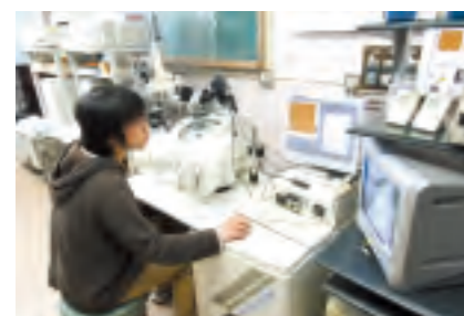
原子間力顕微鏡を使ってナノスケール(10 -9 m)での表面解析を行っている様子
