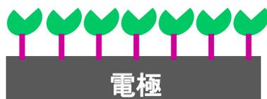
Fig. 2a 配向性の高い酵素固定化
