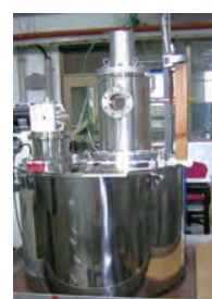
電磁波発生装置 「ジャイロトロン」
