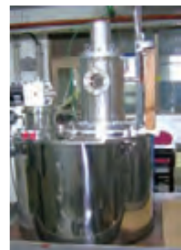
電磁波発生装置「ジャイロトロン」
