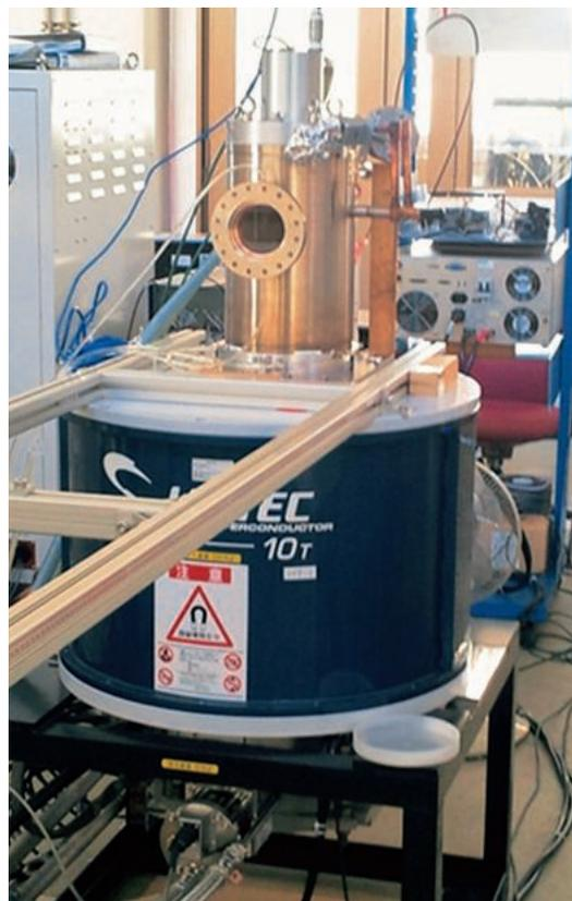
電磁波発生装置「ジャイロトロン」
