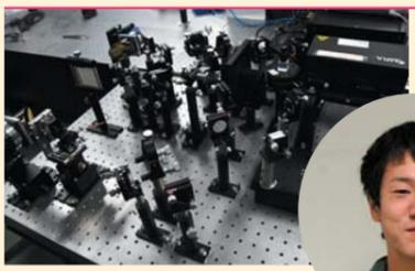
テラヘルツ光を鏡で屈折させながら実験をします。この装置も自作です。
