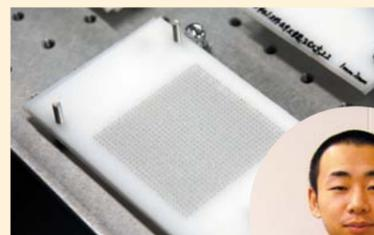
自作の実験道具。5cm四方くらいのスペースに1000個も穴を空け、ばねを差し込んでいます！
