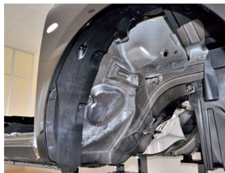
自動車のホイールハウス部に塗装された自動車用防錆塗料「NTガードコート」
