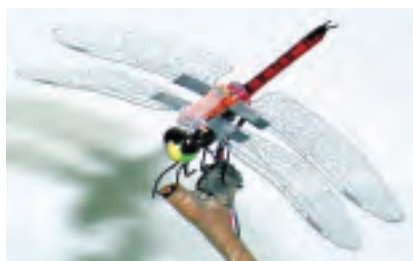
アクチュエータの創成とロボティクス（応用） （周囲の温度に応じて運動性が変化します）
