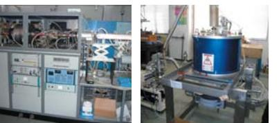
[左] 電磁波によるセラミックス焼結装置。周波数28GHzおよび24GHz。新機能材料の開発研究で活用します [右] CW(定常発振) ジャイロトロンFU CW II。周波数400GHz、タンパク質の構造解析に用います
