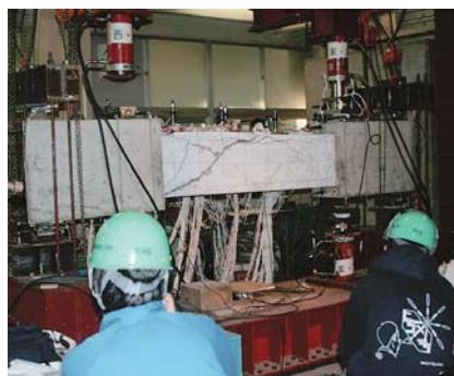
鉄筋コンクリート梁の載荷実験
