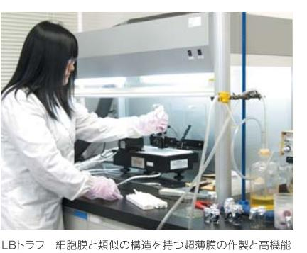
LB脂質アブレーフ装置 細胞膜と類似の構造を持つ超薄膜の作製と高機能化を行っています
