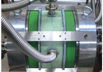
[上] 全超伝導電動機 世界で初めての全超伝導・液体窒素冷却の電動機(パワーエレクトロニクス研究室) [左] デバイス特性評価装置 窒化半導体を用いた新構造トランジスタの基本特性を測定(電子デバイス研究室)
