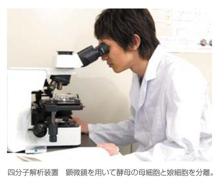
四分子解析装置 顕微鏡を用いて酵母の母細胞と娘細胞を分離。遺伝情報がどのように伝わるかを解析しています
